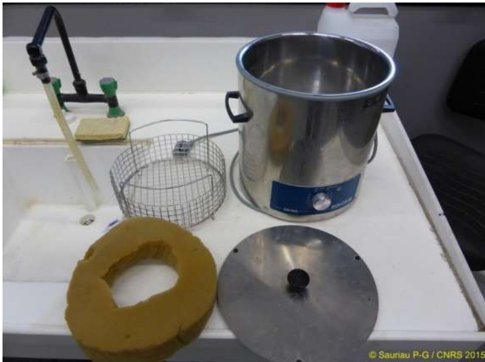
Figure 13 : Bain à ultrasons (A) avec détails du porte tamis et de la collerette en mousse (B) pour maintenir un bol à sédiment. Crédit photos : P.-G. Sauriau CNRS.
