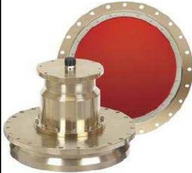
Un A.D.C.P (Acoustic Doppler Current Profiler) est un courantomètre acoustique à effet doppler fabriqué par la société américaine R.D.I (<http://www.rdinstruments.com/>). À chaque impulsion acoustique le courant sur toute la colonne d'eau est mesuré jusqu'à des profondeurs pouvant atteindre 850m.
