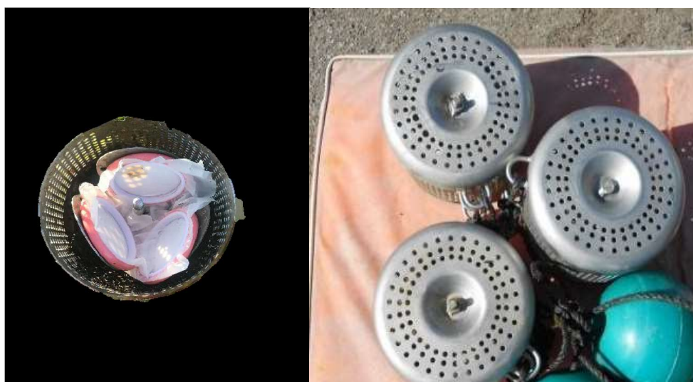
Figure 6. Dispositif SPATT. A gauche : cage ExposMeter ; à droite : triplicat de SPATTs dans un ExpoMeter
