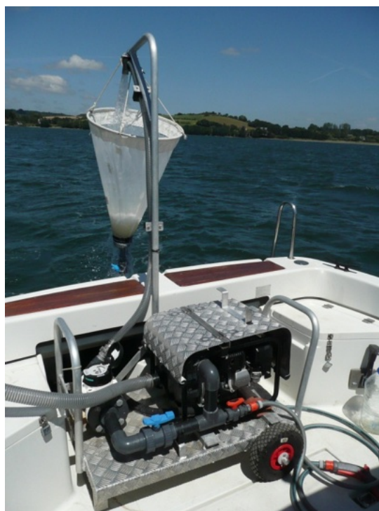
Figure 3 : Système de pompage et de filtration permettant la récolte des échantillons de plancton contenant les larves d'huîtres. La moto-pompe permet de filtrer 1,5 m 3 d'eau de mer en moins de 15 minutes. La maille du filet à plancton est de 40 µm. La mesure précise du volume pompé est fournie par un débitmètre. La crépine de prélèvements est lestée de manière à prélever à 1 mètre sous la surface. Lors du pompage, le bateau fait route au ralenti (vitesse inférieure à 1 nœud). Après pompage, le culot de filtration est transféré dans un flacon plastique de 2 litres tout en rinçant le filet. L'échantillon est formolé ou alcoolisé. Photo : © Cochet-environnement (2009). ►
