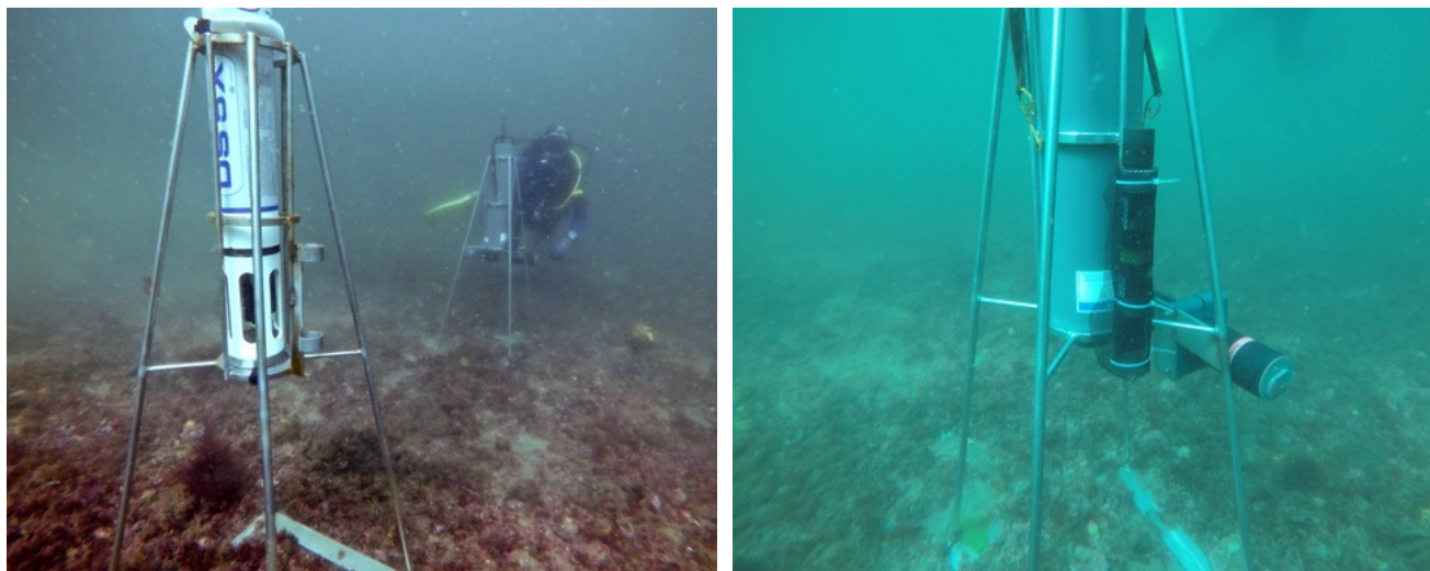
Figure 5 : Vue du site sous-marin d'instrumentation du banc du Roz (Baie de Daoulas). Photo de gauche : jeux de sondes déployées sur le fond, photo de droite : détail des capteurs pH, STPS et ECO FLNTU.
