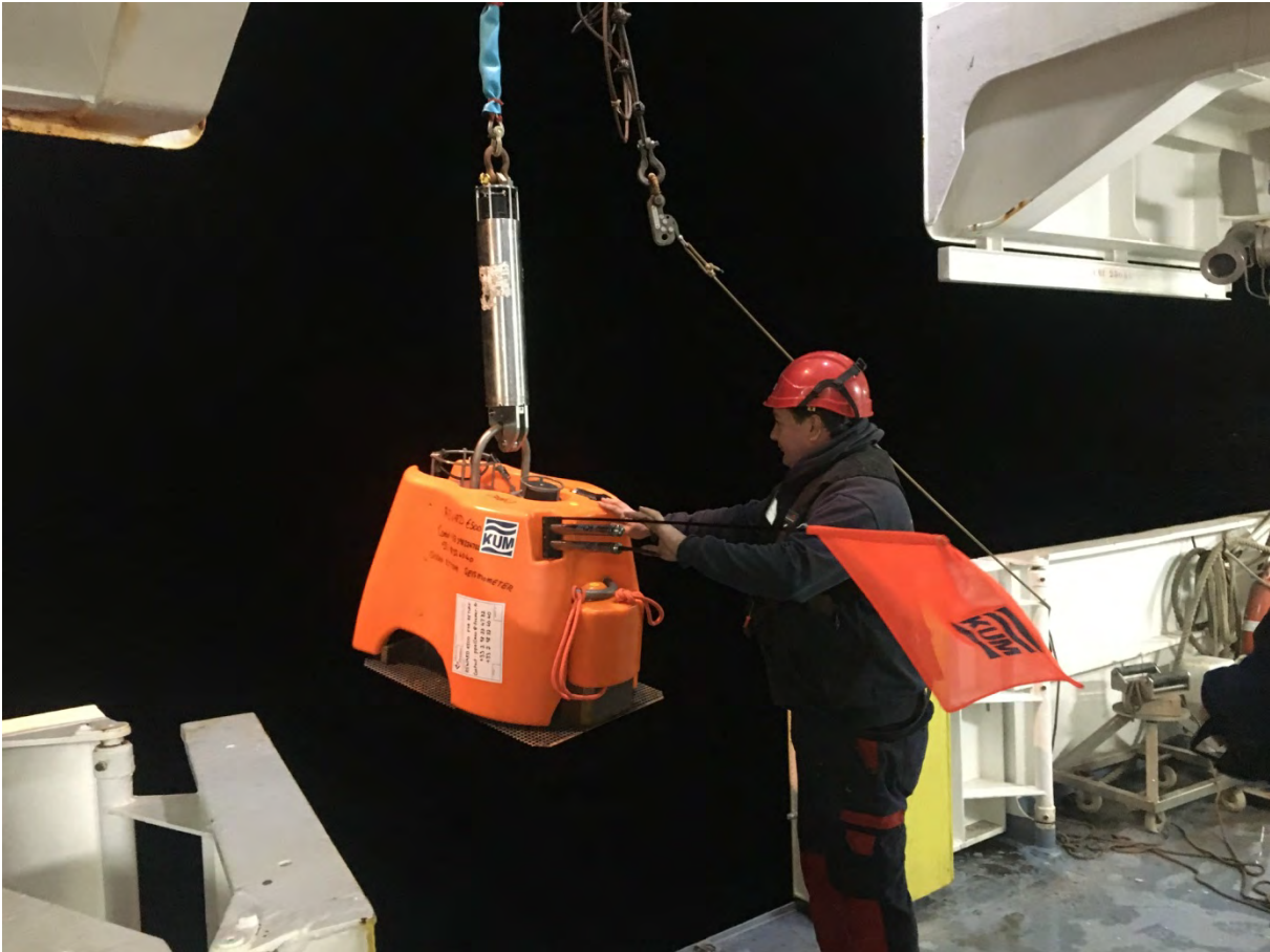
Figure 4 : déploiement d'un OBS large bande NAMMU. Le treuil hydro est équipé d'un largueur BUC. La position du point de déploiement est celle relevée au point de largage à 50 mètres du fond.
