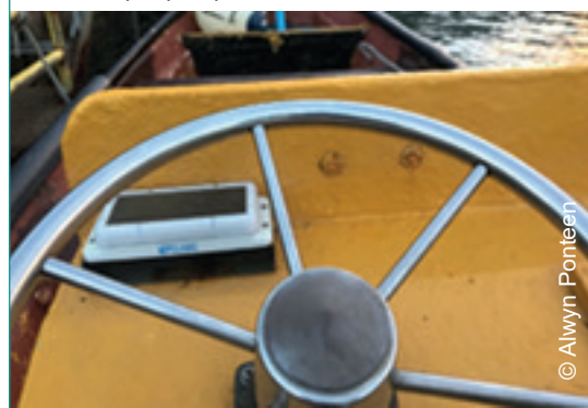
Foto 8. SLB de Pelagic Data Systems instalado en un buque pesquero
