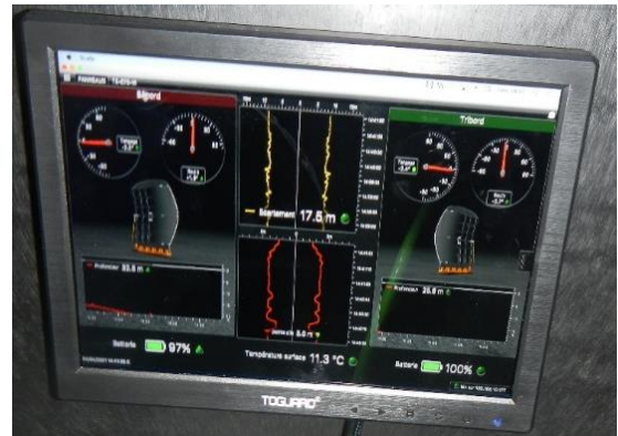
Figure 1 : plan du chalut Ifremer NourDem 11,90-16,45 m. Détail des bras et entremises (en bas à gauche). Capteur « NetSonde » positionné au centre de la corde de dos afin de mesurer l'ouverture verticale du chalut (en haut à droite). Positionnement sur un panneau du capteur d'écartement de panneaux (à droite au centre), et écran du PC permettant le suivi en direct de l'écartement des panneaux et de leur inclinaison/angulation tout au long du trait (afin de valider le trait, ou éventuellement de l'annuler si l'écartement sort des tolérances qui sont fixées à 15 et 20 m).
