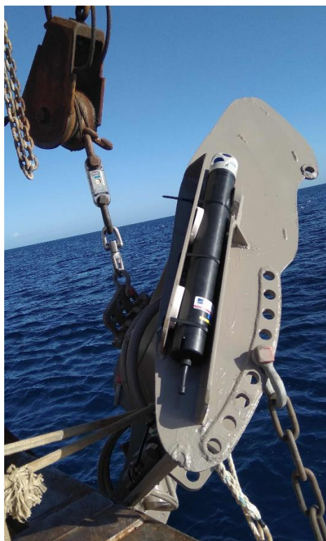
Photo 5 : montage de l'ADCP sur le haut du panneau, parallèlement à la corde.
