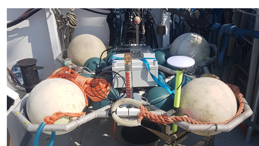
« Trefle » buoy with low-cost GNSS system
