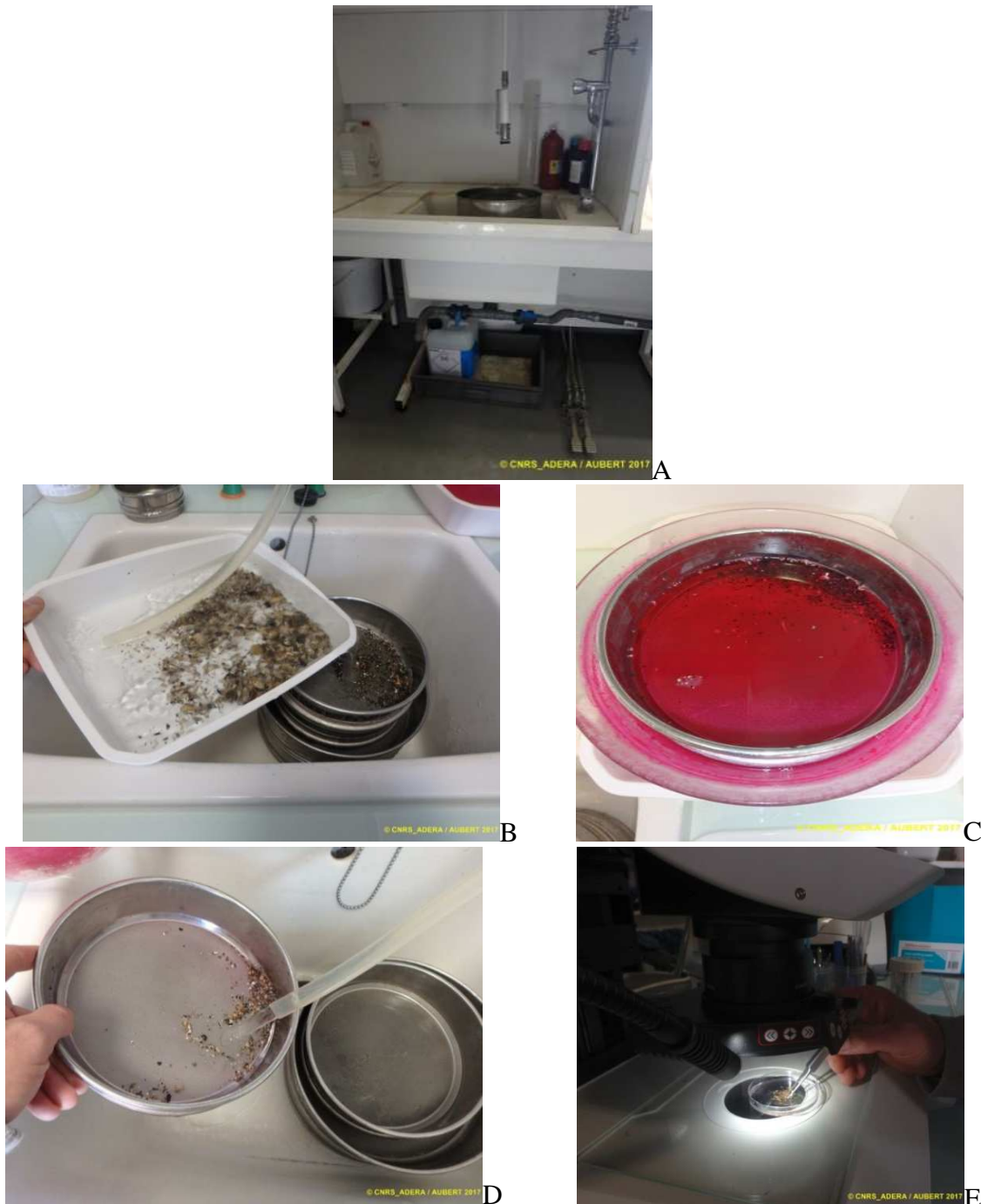
Fig. 68 : Opération de rinçage des eaux de fixation puis de lavage à grande eau (A), tri hydraulique (B), coloration des refus de tamis (C) et rinçage (D) puis de tri à la loupe binoculaire des éléments les plus fins (E)
