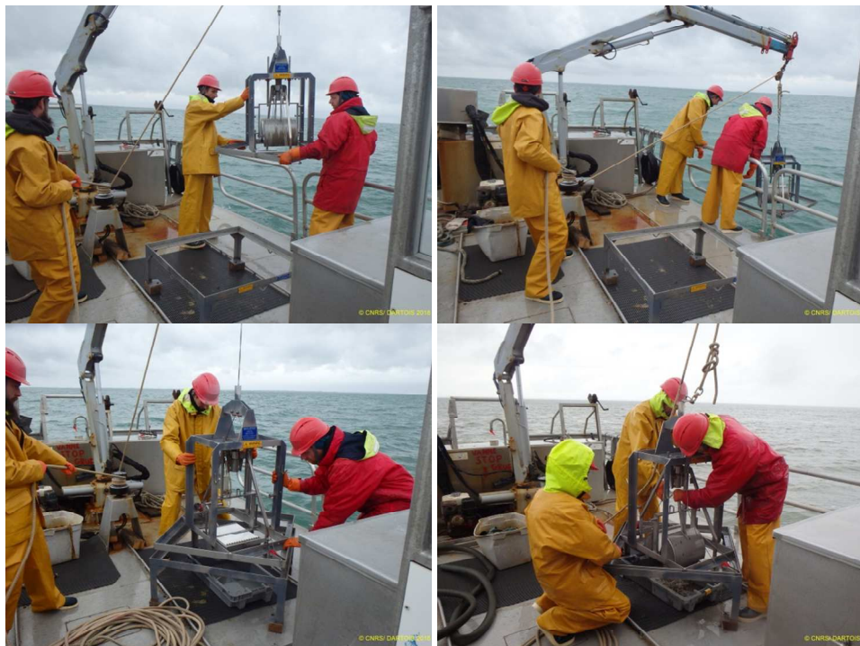
Fig. 51 : Déroulement des opérations lors d'un prélèvement à la benne Smith
