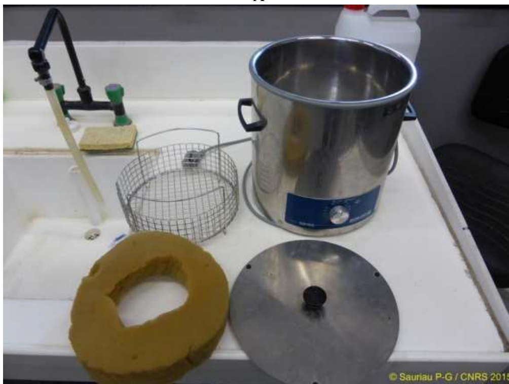
Fig. 66 : Bain à ultrasons (A) avec détails du porte tamis et de la collerette en mousse (B) pour maintenir un bol à sédiment
