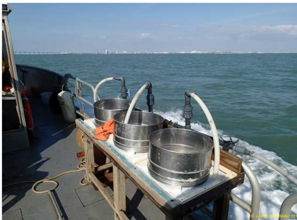
Fig. 52 : Navire L'Estran de l'Université de La Rochelle utilisé pour l'échantillonnage DCE (en haut) et vue de la table de tamisage à bord, tamis maille carrée 1 mm (en bas)
