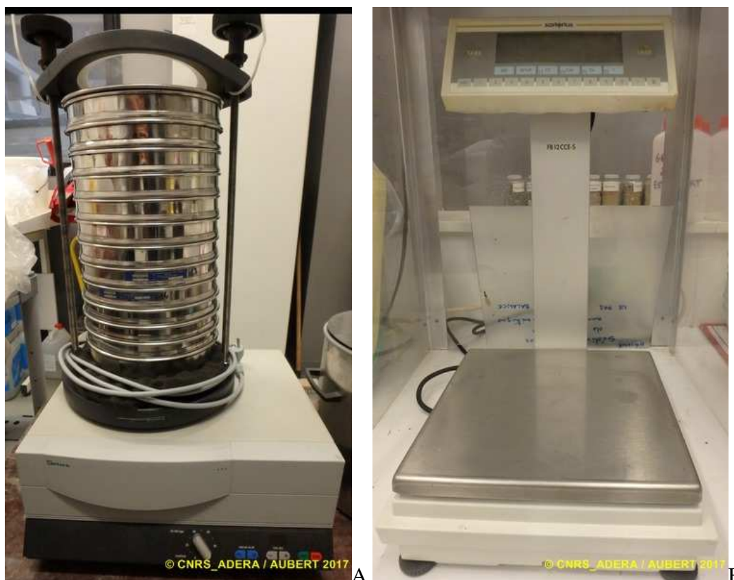
Fig. 65 : Colonne de tamis normalisés AFNOR sur tamiseuse Retsch (A) et balance Sartorius à 0,01 g (B)
