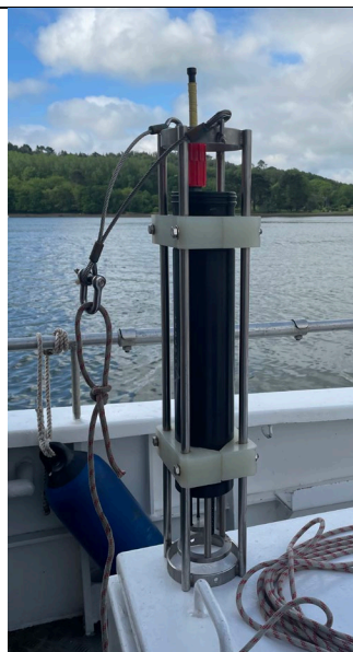
Figure 5-2 : bathycélérimètre, instrument de mesure de température et de salinité
