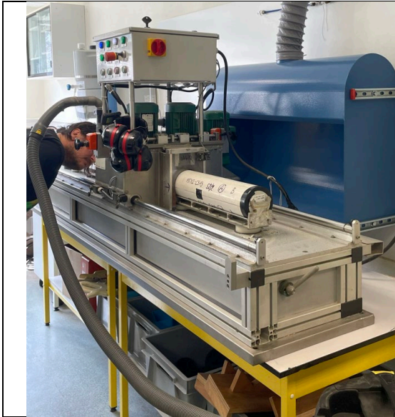
Figure 4-1 : ouverture d'une carotte
