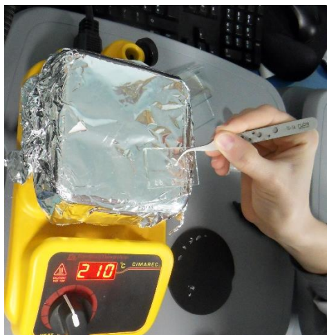
Figure 5 : Encollage des otolithes d'anguilles communes à 210°C sur une lame de verre type lame de géologie.
