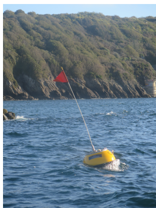
FIGURE 1 – Bouée Datawell Waverider Mk-III déployée sur le site de Sainte-Anne du Portzic.
