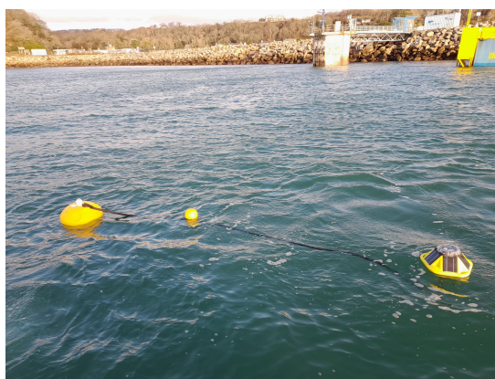
FIGURE 2 – Bouée Sofar Ocean Spotter (droite) déployée sur le site de Sainte-Anne du Portzic avec son flotteur (gauche).
