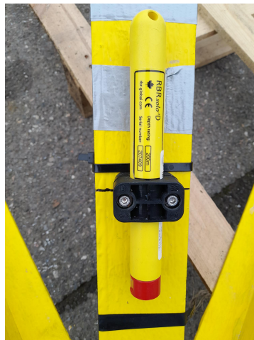
FIGURE 3 – Vue de près du RBR D-200m fixé sur la cage instrumentée à l'aide d'un collier Stauff. La membrane piezo-électrique se trouve sur la partie rouge.
