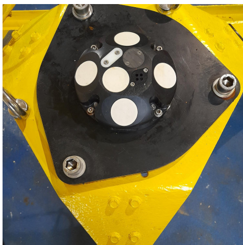
FIGURE 4 – Vue de près de l'ADCP. Les cinq disques blancs correspondent aux membranes servant à émettre et recevoir les signaux ultrasons.
