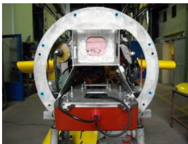
Figure 10 : Antenne Tx et Rx dans la section charge utile de l'AUV.
