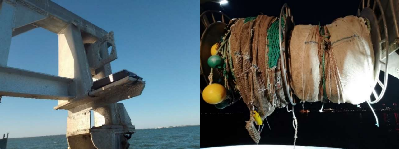
Figure 10 : Système MOANA du constructeur ZebraTech testés dans le cadre du projet DELMOGES (boîtier multifonction à g. et sonde à d.)
