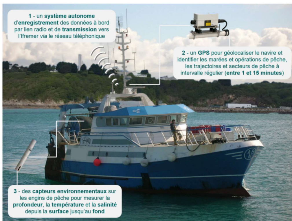
Figure 2 : Schéma de principe du fonctionnement du dispositif RECOPECA
