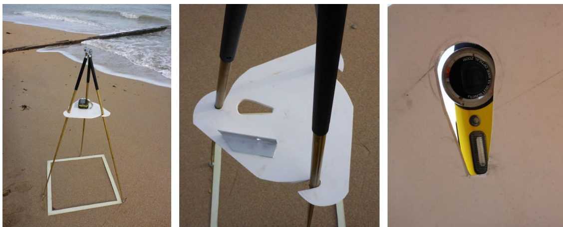
Figure 20 : Trépied et support utilisés pour réaliser les photos des herbiers de zostères naines.
