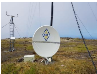
fig 3: Boîtier contenant l'électronique de la station et parabole sur l'île de la Possession
