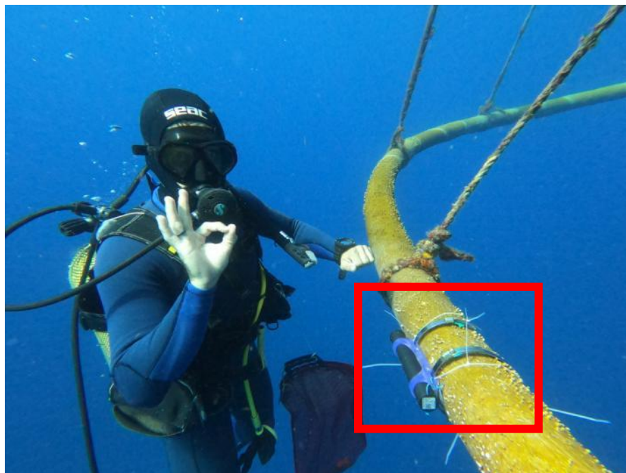
Figure 5 - Installation du capteur de pression WisensTD sur le tore lesté en bas de la cage
