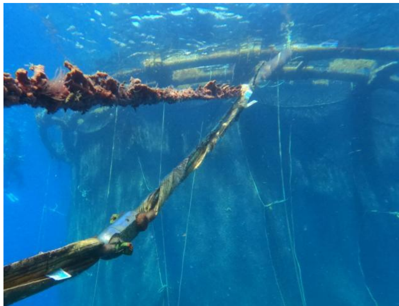
Figure 7 - SF10 sur haussière - Montage parallèle
