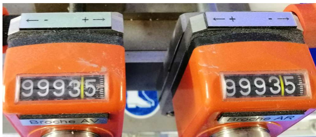
Fig. 3 : Positionnement des broches (fraises) pour une épaisseur de chemise comprise entre 7,5 et 8mm
