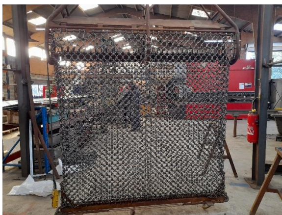
Figure 1 : Drague bretonne (Ø 50 mm) utilisée durant la campagne COMOR
