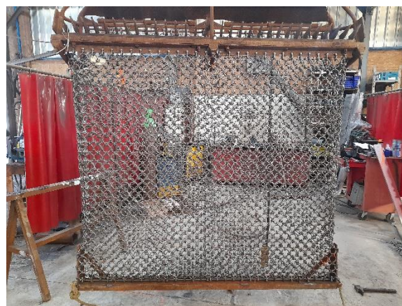
Figure 3 : Drague bretonne (Ø 72 mm) utilisée durant la campagne COMOR
