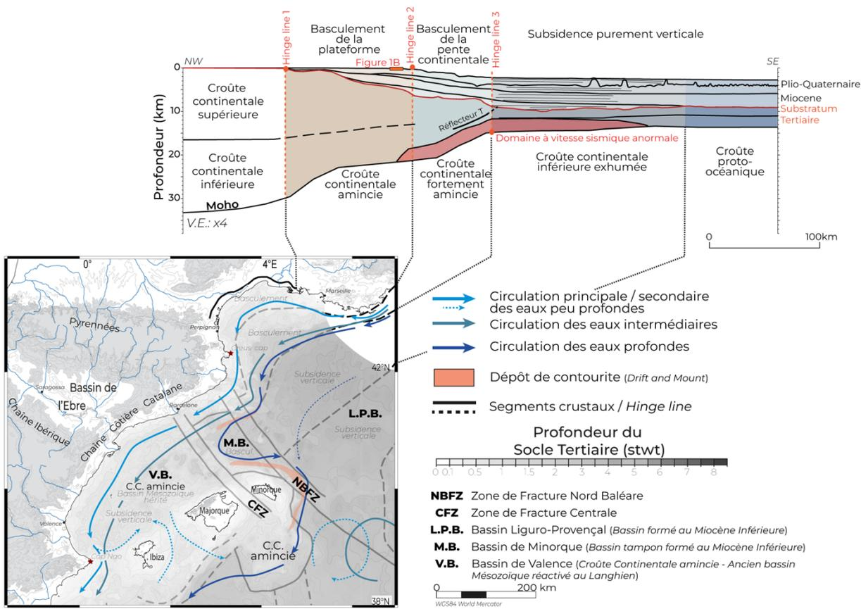
**Fig. 6-2.** - Les différents domaines de subsidence de la marge du golfe du Lion: en vue verticale (modifiée de Leroux *et al.* 2015) et en plan. Les flèches bleues représentent la circulation de surface, intermédiaire et profonde et le dépôt local/régional de contourites dans le sous-bassin spécifique de Minorque (modifiée de Pellen *et al.* 2016 ; 2019 ; Miramontes *et al.*, 2019).
