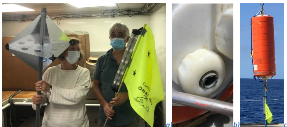
Figure 17 : Coins radar avant (a) et après déploiement: le cube a été arraché (b) mais le tube a résisté (c).
