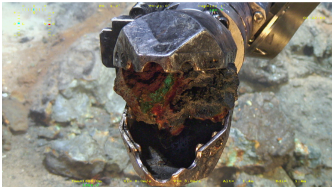
Figure 5-4 Un fragment de cheminée hydrothermale éteinte contenant des oxydes de cuivre, prélevé pour datation du site Sintra (site hydrothermal Lucky Strike sur la dorsale médio-atlantique) Photo Victor6000 (Source : Journal de bord de la campagne MomarSat, 2011) Le diamètre de la pince est d'environ 15cm.
