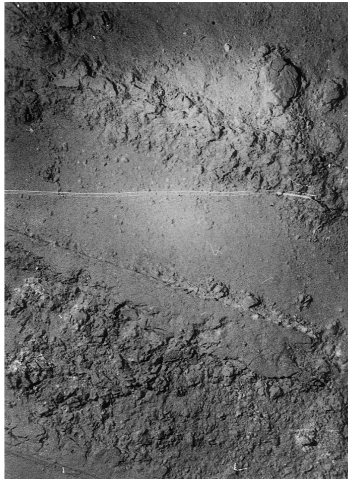
Figure 5-9 Traces des impacts laissés par les jets d'eau et les patins du BIE Disturber dans la zone Clarion-Clipperton (source: Interoceanmetal, dans Oebius et al, 2001).
