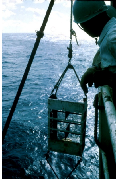
Figure 3-29 Descente d'une drague sur le câble du CLB.
