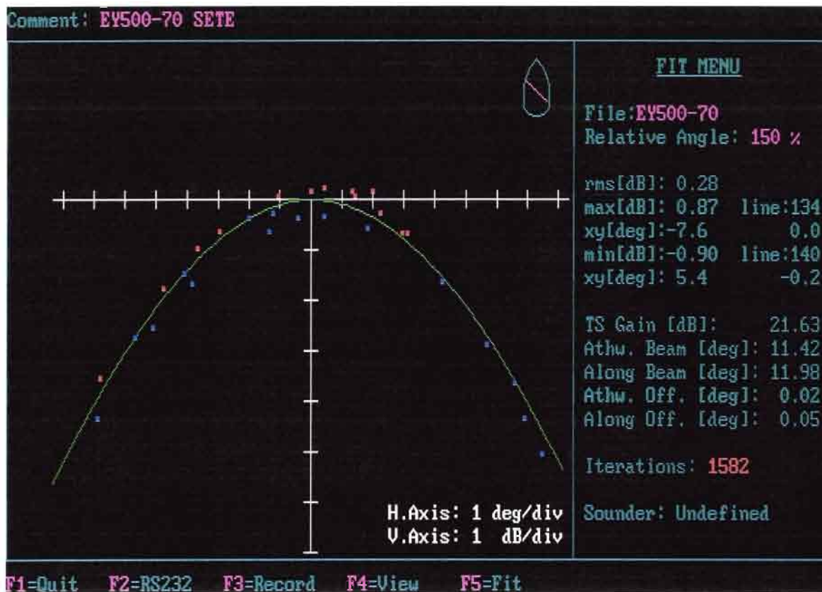
Figure 3 : Le pattern du faisceau peut être représenté selon différentes coupes 0, 45, 90 et 135 degrés.
