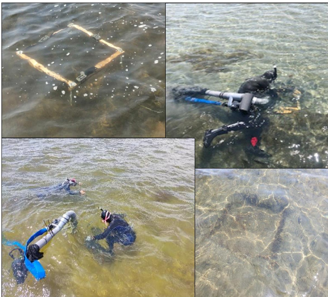
Figure 11 : Prélèvement des échantillons dans les fonds de profondeur inférieure à 1,50m à l'aide d'une mini-drague aspiratrice à eau
