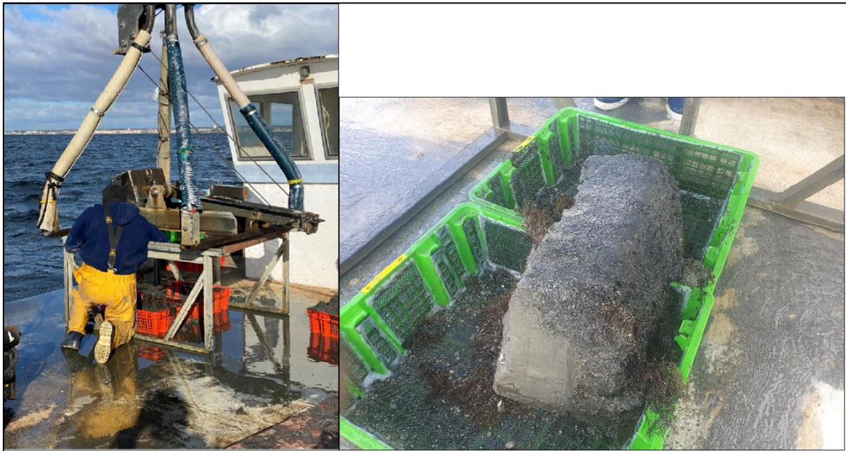
Figure 8 : la Benne Hamon (à gauche) et la collecte d'un échantillon sur la barge conchylicole (à droite)
