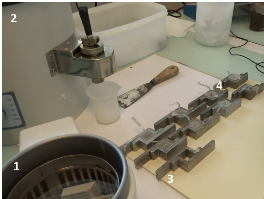
FIGURE 3.2 – Plan de travail pour l'inclusion des pièces en paraffine avec 1) panier chauffant contenant les cassettes histologiques avec les pièces ovariennes dans le bain final de paraffine, 2) distributeur de paraffine liquide, 3) deux barres de Leuckart positionnées pour accueillir le prochain échantillon, 4) barres de Leuckart avec échantillon inclus en paraffine et son étiquette d'identification
