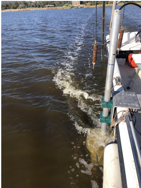
Figura 4. Foto che mostra l'installazione dei trasduttori (transceivers) su un palo metallico verticale contro la barca nella laguna di Burano. Foto di JP Goiran.
