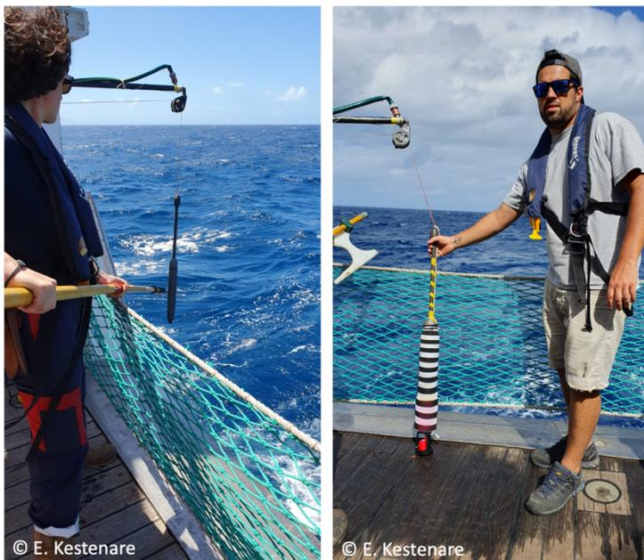
*Figure 27: Mise à l'eau de l'ogive de test (à gauche) et sonde RBR #2 équipée de sa chaussette anti-requins (droite) avec bout de sécurité.*
