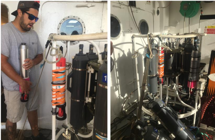
Figure 25: Sondes ecoCTD attachées à la rosette pour les profils d'intercalibration
