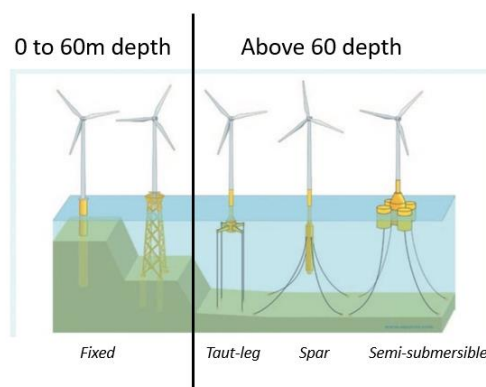
Figure 0.14 – Principales technologies de flotteurs pour les éoliennes offshore. Gauche (2) : posées. Droite (3) : flottantes.
