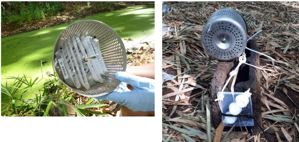
Figure 9 : Photographies des cages prêtes à être déployées, à gauche la membrane silicone, à droite les DGT
