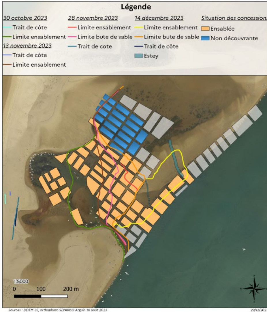
Figure 9 - Plan de situation "Arguin Conche Sud" du 14 décembre 2023 : le trait de côte correspond à la limite du jet de rive levé à marée basse sur la face océanique, la limite d'ensablement correspond à la limite du jet de rive sur la face est du banc d'Arguin et la limite de la butte de sable correspond à la rupture de pente entre le cordon sableux et la plage (©DDTM33)
