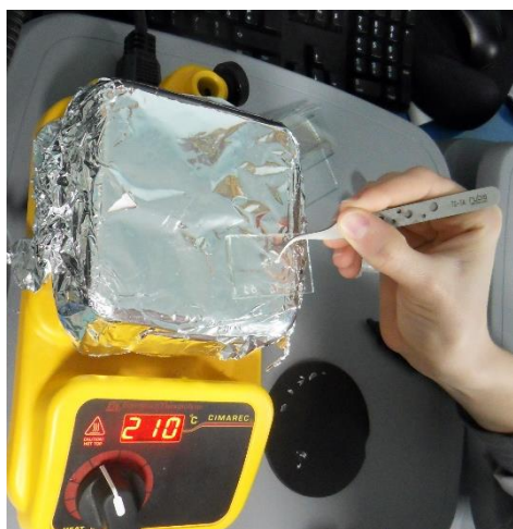
Figure 5 : Encollage des otolithes d'anguilles communes à 210°C sur une lame de verre type lame de géologie.
