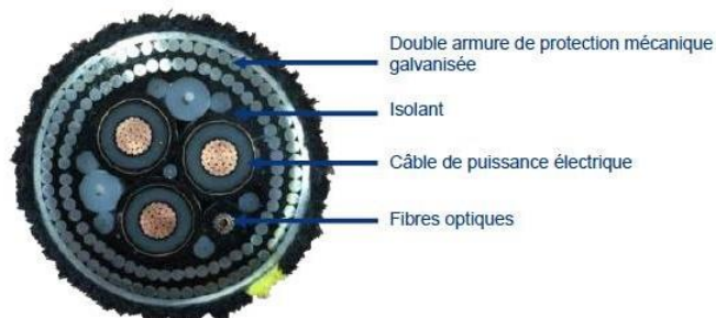
Figure 4.1 : Gauche : Description du câble sous-marin FOCUS de diamètre 9 mm avec 5 fibres optiques (source : G. Cappelli). Droite : Section du câble hybride sous-marin électro-optique (20 000 V) de 119 mm comportant 48 fibres optiques (Source Enedis).
