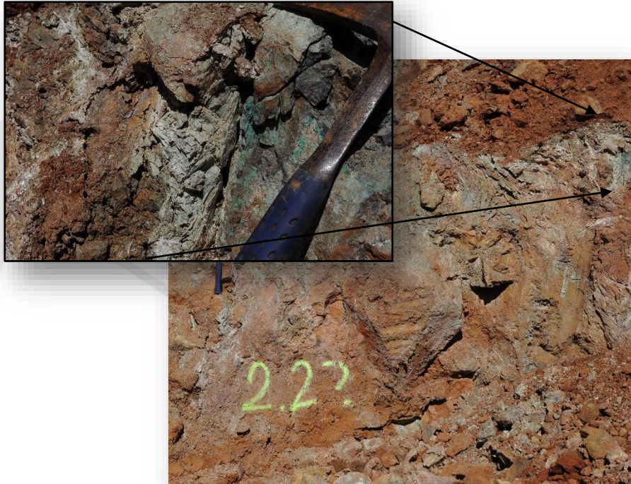
Figure 5 : Exemple de prélèvement de roches amiantifères à antigorite, sur le site minier de la Tontouta
