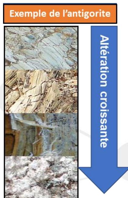
Figure 3 : Évolution du minéral asbestiforme, Antigorite, sous l'effet de l'altération de surface (d'après Petriglieri et al., 2019 et fiches entreprises minières calédoniennes)
