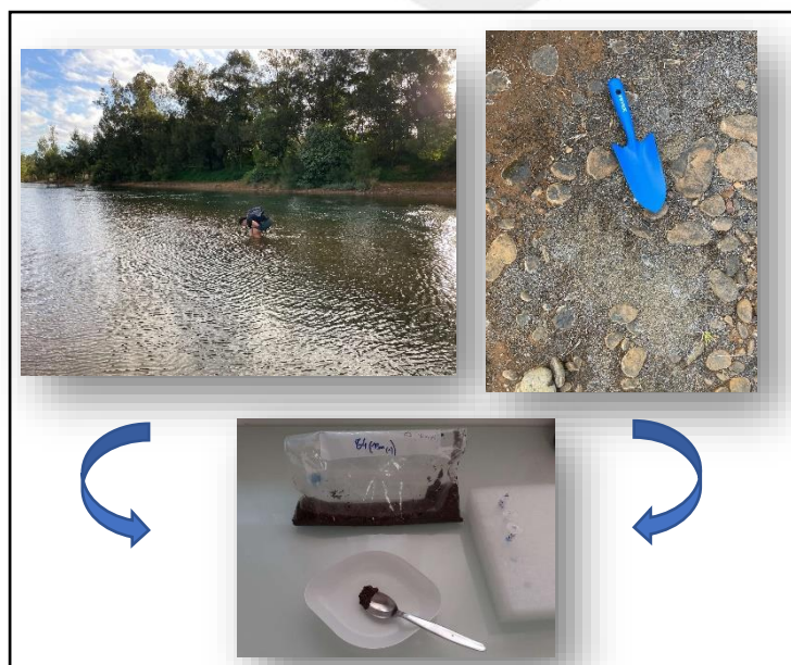
Figure 7 : Échantillonnage des sédiments immergés (à gauche) et émergés (à droite). Exemple de prélèvement analysé à la loupe binoculaire (en bas)
