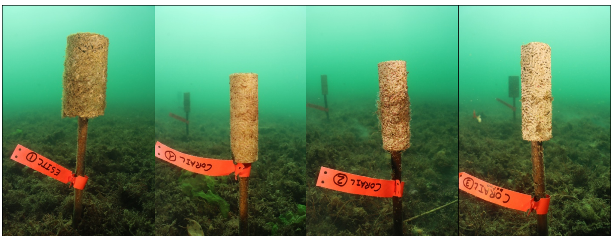
Figure 47 : Déploiement du nouveau champ d'éco-modules en juillet 2023 (Béton calcaire avec Builders, Béton écologique et Bio polymères PHA-PLA avec Corail Artefact). Les collecteurs, de forme cylindrique, font 15 cm de haut pour 8 cm de diamètre. Photos : © Matthias Huber/Ifremer.
