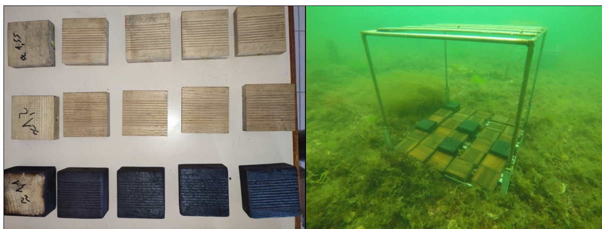
Figure 34 : Évaluation d'une essence de bois (Robinier faux acacia) pour la restauration écologique de l'huître plate (Test 2022) : Échantillons testés et mise en œuvre sur le laboratoire sous-marin du Roz en Rade de Brest (photos : © S. Pouvreau/Ifremer)
