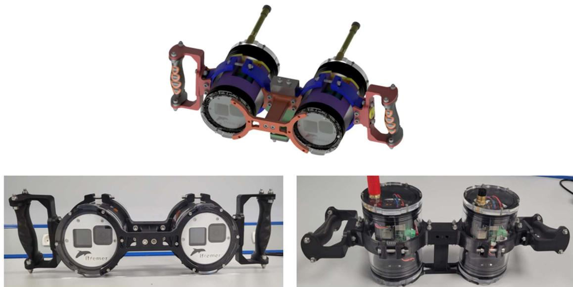
Figure 5 : Système stéréoscopique d’acquisition de vidéos sous-marines
