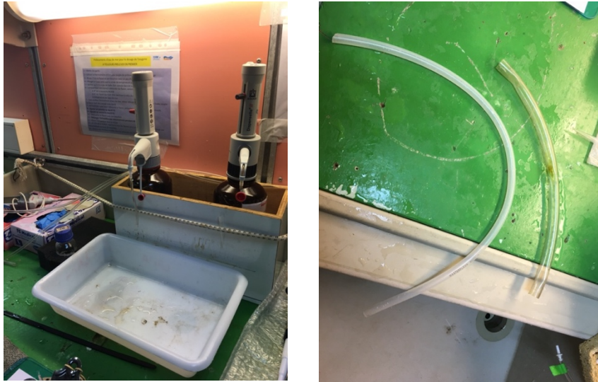
Figure 10: panneau de gauche : installation des réactifs dans le laboratoire humide. L'embout de la dispensette sur R1 est celui fourni par Martine. On voit également le petit flacon de R2 calé dans de la mousse. Panneau de droite : les deux tuyaux utilisés pour le prélèvement des Niskins. A droite, le tuyau fourni, trop rigide. A gauche, le tuyau fourni par Martine et utilisé à partir de la station 002, plus adapté.
