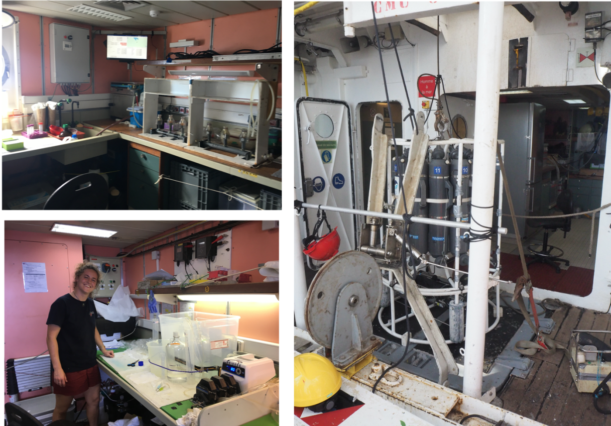
Figure 7: Installation du laboratoires sec (en haut) avec la rampe de filtration pour la chlorophylle, et du laboratoire humide (en bas). A droite, bathysonde avec ses 12 bouteilles positionnée sur le moon pool.
