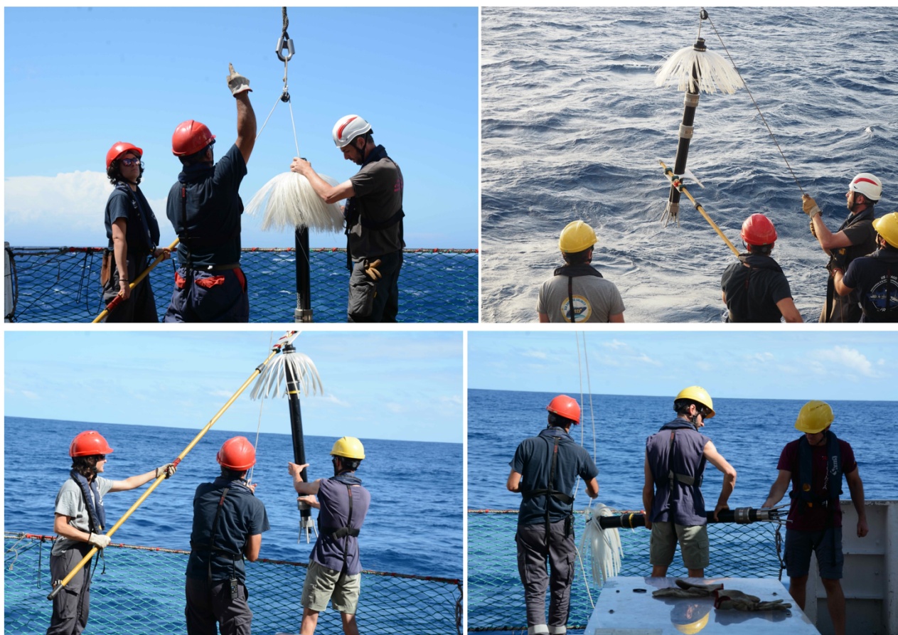
Figure 8 : Opérations de mise à l'eau et de récupération du VMP pendant la mission SWOTALIS3, pendant les quarts 8-12 et 0-4
