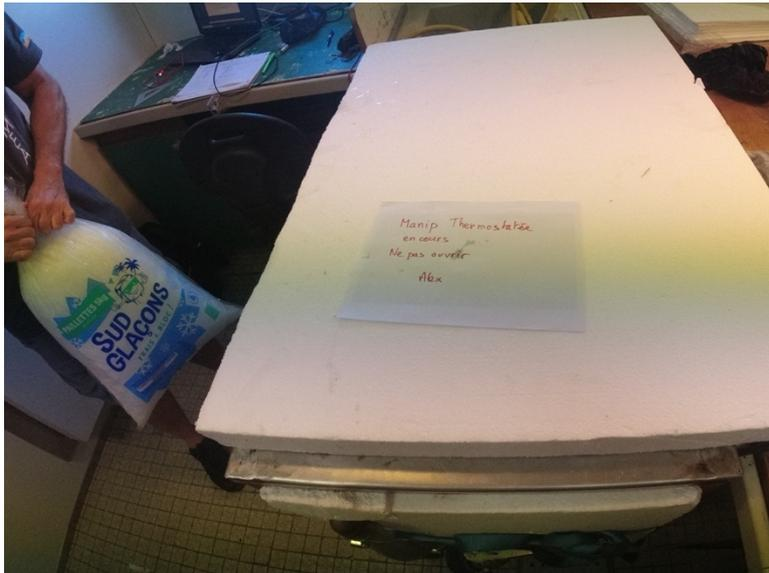
Figure 15 durant les phases 1 et 3, le bassin est fermé par un couvercle en polystyrène
