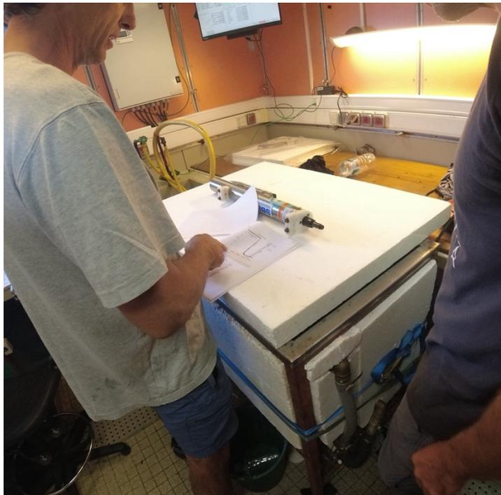
Figure 14 : Les parois du bassin sont isolées ; on distingue la sortie de la pompe de brassage, le tuyau vertical. La pompe est située sous le bassin.
