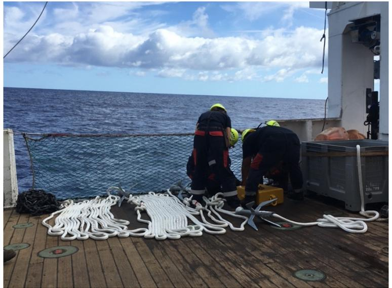
Figure 10:(gauche): design de la ligne de grappins. (droite): préparation de la ligne de grappins pour tenter de récupérer la cage C1, restée au fond
