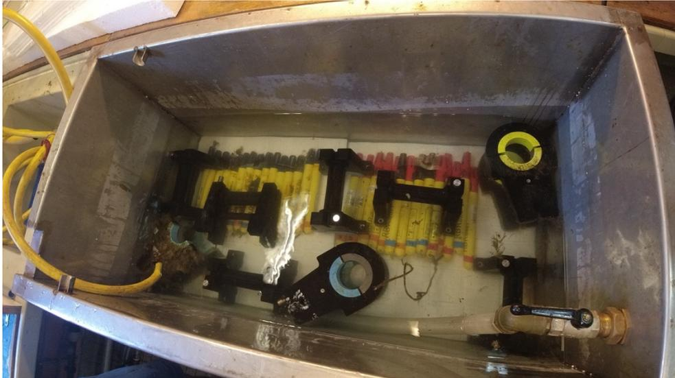
Figure 13 : disposition des capteurs : la sortie de la pompe de brassage (vanne) donne sur un tuyau (transparent) qui dirige le flux vers la gauche
