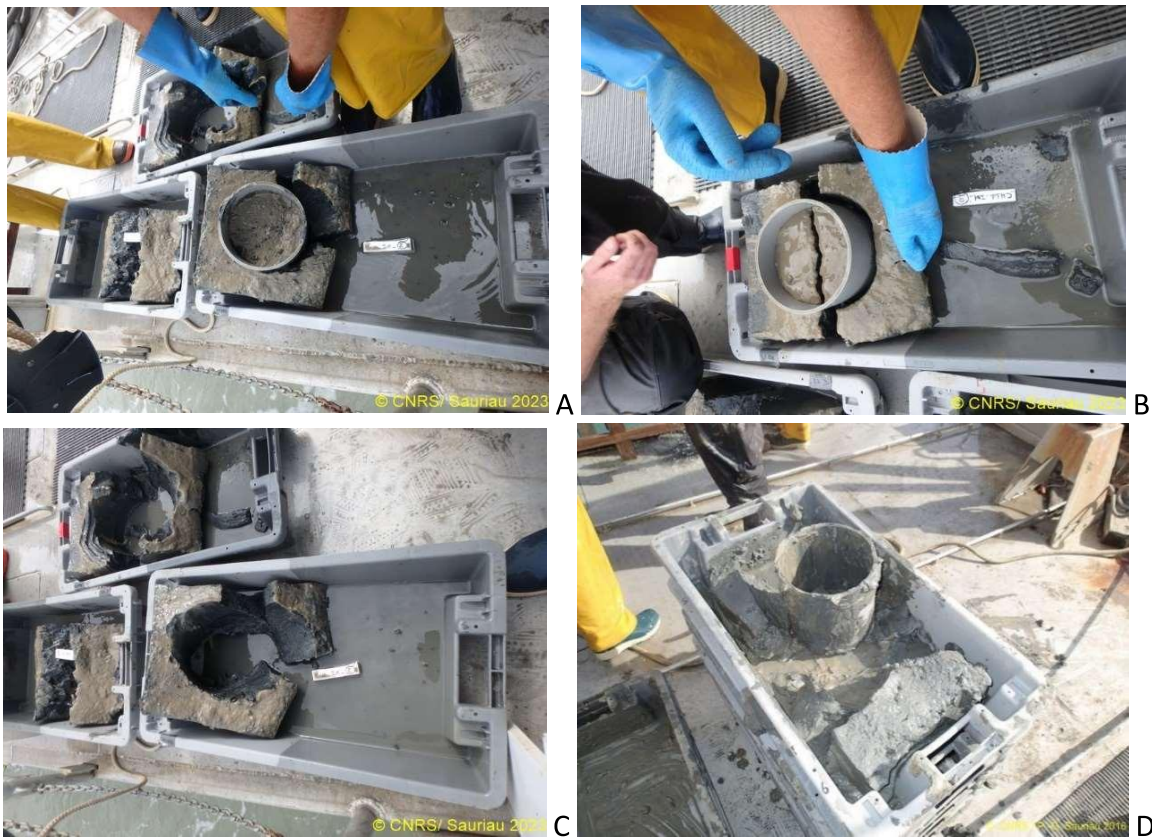
Figure 6 : Déroulement des opérations lors d'un prélèvement au carottier sur le volume prélevé à la benne Smith McIntyre (A : carottier rempli, B : carottier manipulé, C : volume prélevé et D : carottier vide). Photo P.-G. Sauriau CNRS ©.
