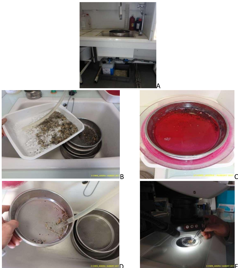
Figure 17 : Opération de rinçage des eaux de fixation puis de lavage à grande eau sous Sorbonne (A), tri hydraulique (B), coloration des refus de tamis (C) et rinçage (D) puis de tri à la loupe binoculaire des éléments les plus fins.
