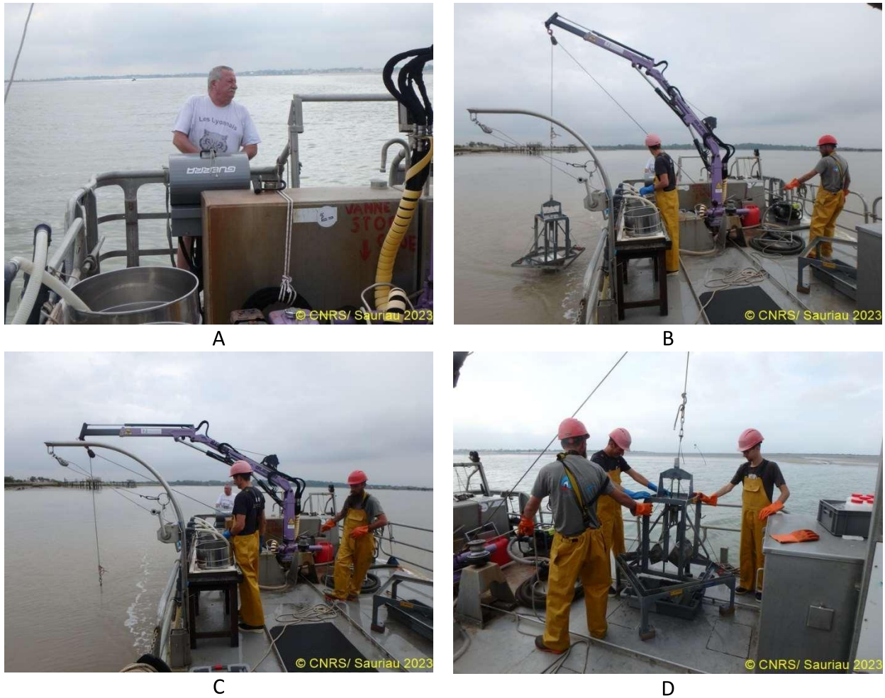
Figure 4 : Déroulement des opérations lors d'un prélèvement à la benne Smith McIntyre. Commande de la grue (A), Mise à l'eau de la benne (B), remontée de la benne (C) puis ouverture de la benne pour récupération de l'échantillon (D). Photos P.-G. Sauriau CNRS ©.
