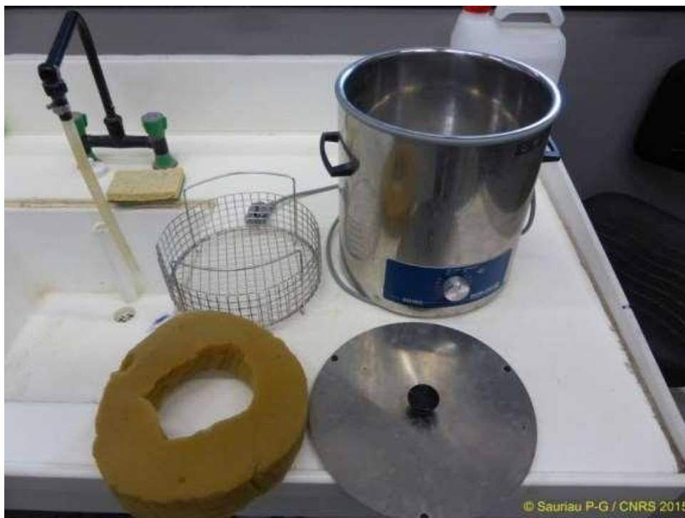
Figure 15 : Bain à ultrasons (A) avec détails du porte tamis et de la collerette en mousse (B) pour maintenir un bol à sédiment. Photo P.-G. Sauriau CNRS ©
