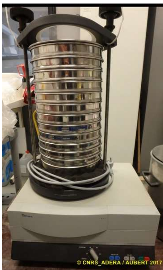
Figure 12 : Colonne de tamis normalisés AFNOR sur tamiseuse Retsch (A) et balance Sartorius à 0,01 g. (B). Crédit photos : Aubert F. / Cohabys.
