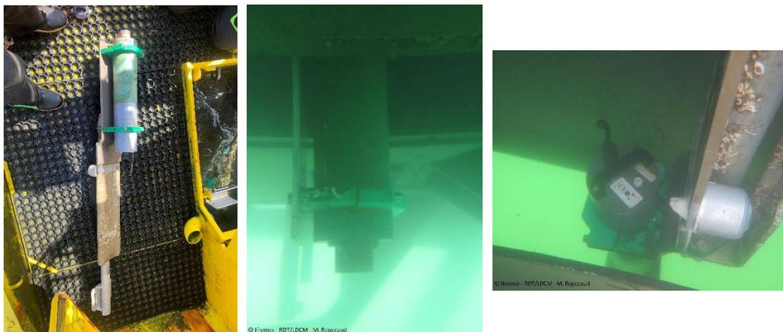
Figure 10 : installation de la sonde pH SeaFET sur le nouveau support le 19/07/23
