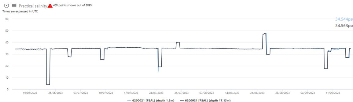
Figure 12 : Salinité mesurée par la station MOLIT en sub-surface (en bleu) et au fond (en noir) sur la période du 15/06/23 au 15/09/23
