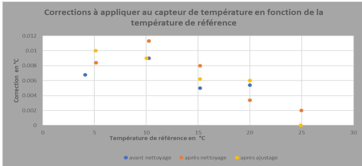
Dans les conditions de l'étalonnage, l'incertitude élargie sur les corrections à appliquer aux indications délivrées par le capteur (corrections non incluses dans l'incertitude) est estimée à :
