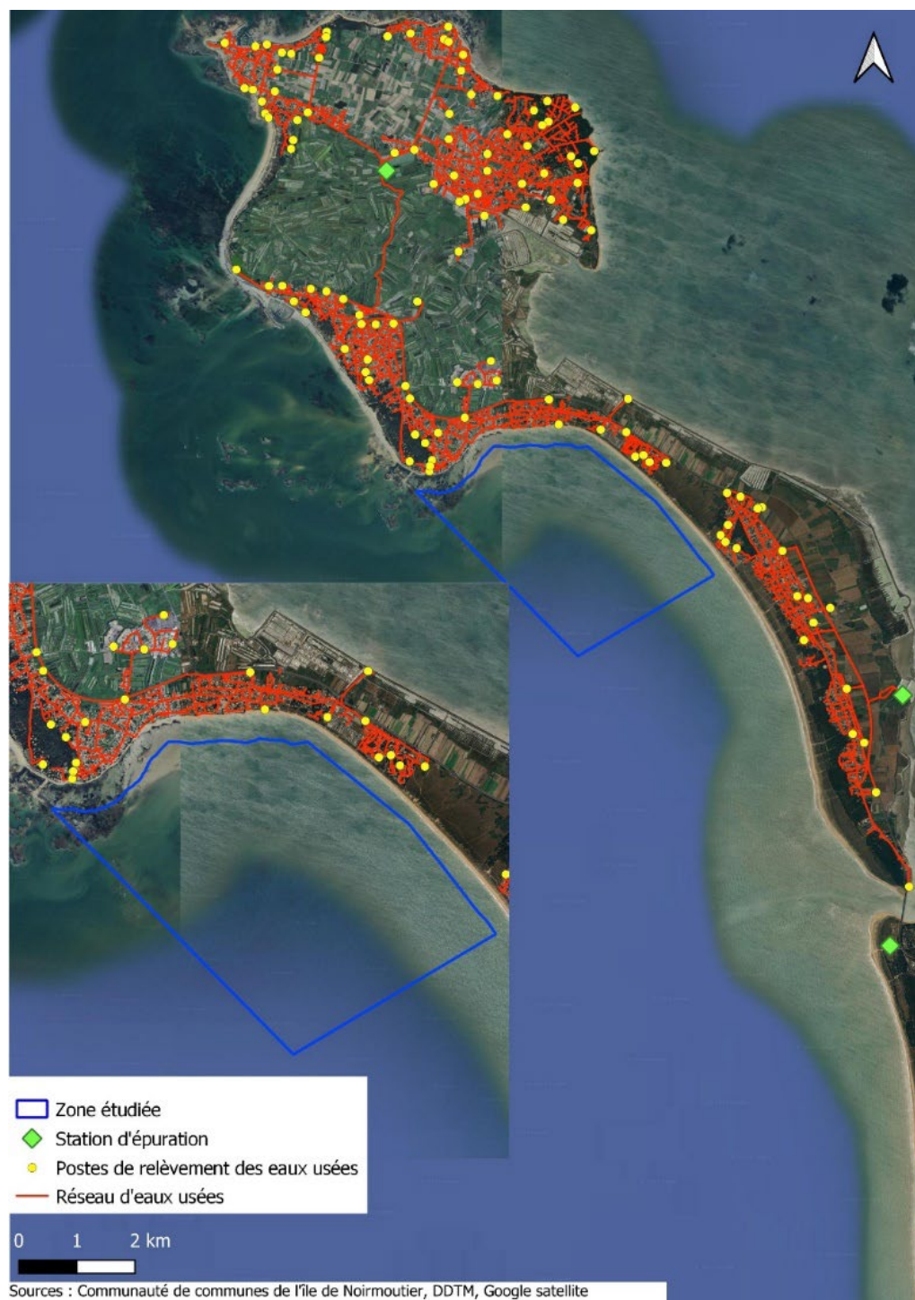
Figure 9 : réseau d'eaux usées sur l'île de Noirmoutier
