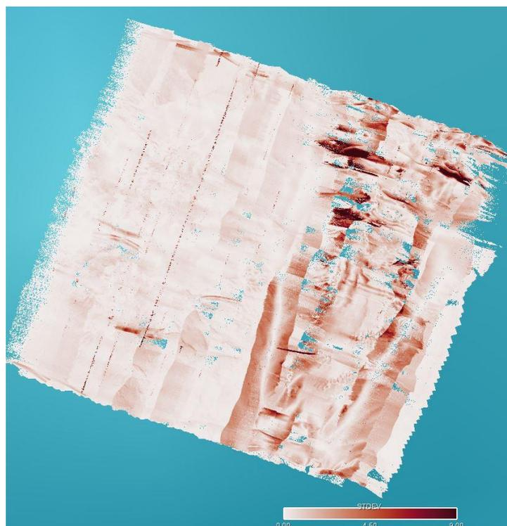
Figure 80: Ecart-type des sondes de la plongée 13
