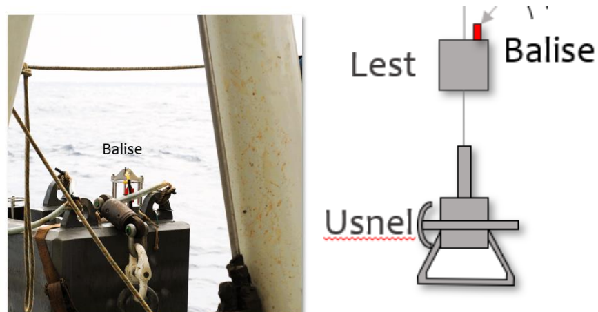
Figure 18 : Installation de la balise BUC sur le lest lors de la campagne EDEN.
