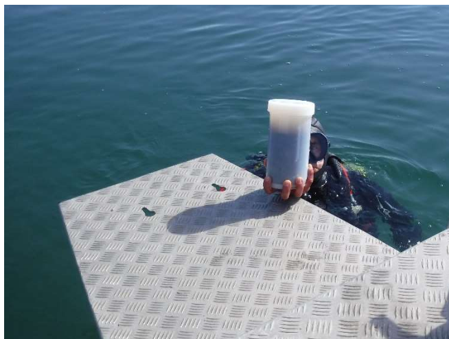
a Figure 3 : Utilisation d'un tube en plongée : a- retour du tube fermé à la surface (campagne ROCCHSED 2023) b- schéma du tube ouvert aux deux extrémités
