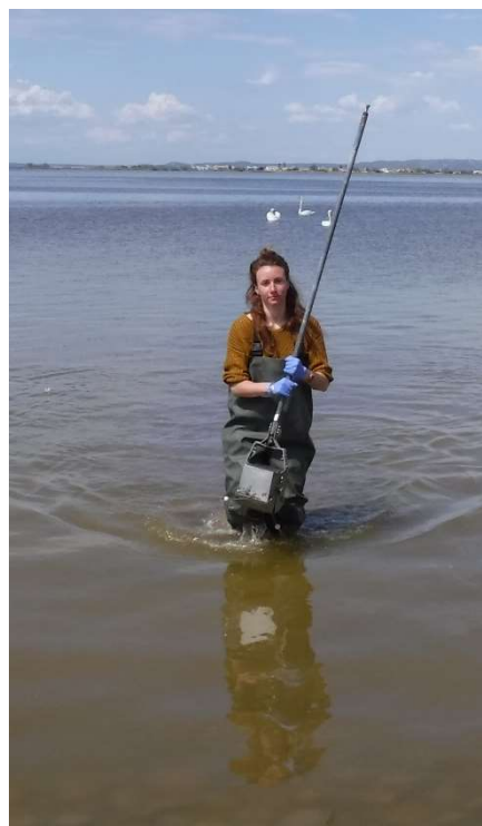
Figure 2 : Carottier – boîte de type Ekman : a-description du matériel (extrait de Ekman, 1911) b- manipulation (après déclenchement) d'un carottier équipé d'un manche (campagne ROCCHSED 2023)
