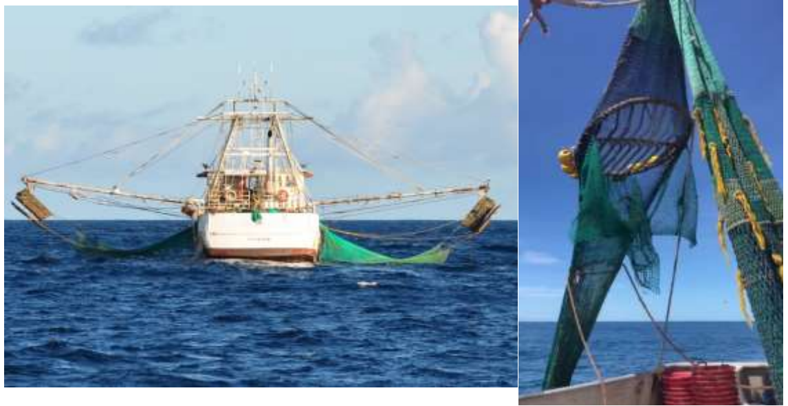
Fig. 1. Photo d'un crevettier et du dispositif T-TED installé (crédits Y. Rousseau)
