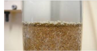
Filtration sur sable
