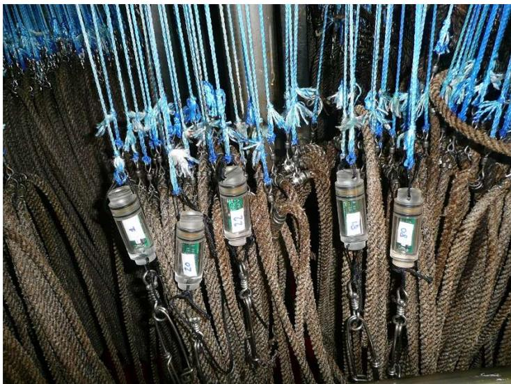
Figure 12. *Mise en place des modules sur un rail (avançons en cordé bleu). (Ifremer / B. Vincent)*
