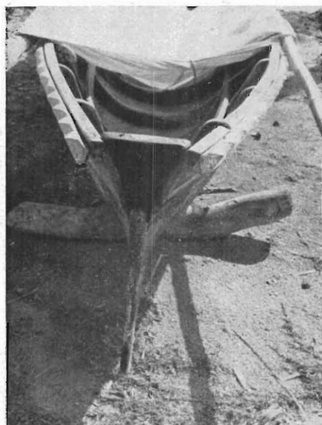
PHOT. 3. — Arrière de gommier (le tableau).
